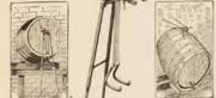
**Figur 100 K. I. Faßwinde - Winde**
