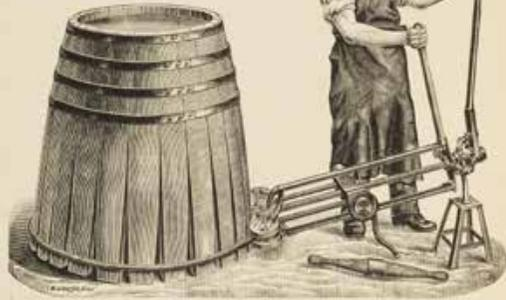
**Figur 101. Separate Faßzugspindel**
